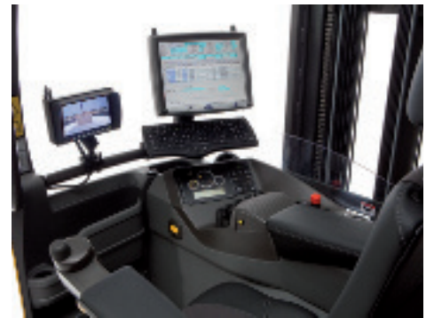
Klemborden, terminals en andere hulpmiddelen kunnen worden bevestigd aan de E-bar
