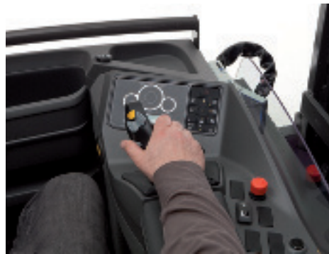
De nieuwe bedieningshendel maakt het mogelijk om drie hydrauliefuncties tegelijkertijd te bedienen
