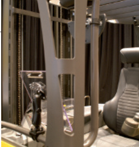
De dakstijl is voorzien van extra openingen voor een optimaal zicht en maximale veiligheid
